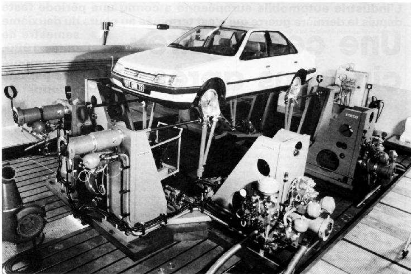
Simulateur d'endurance (© PSA).
