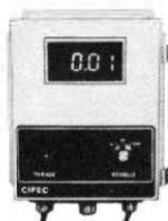
**Turbidimètre industriel, mesure continu avec enregistrement**
