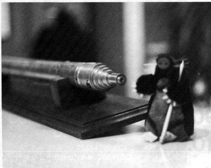
La MINI GRUNDI de Ø 45 mm a été conçue à la fois pour la pose des câbles de télévision et des fourreaux pour des petits branchements en faible profondeur.
