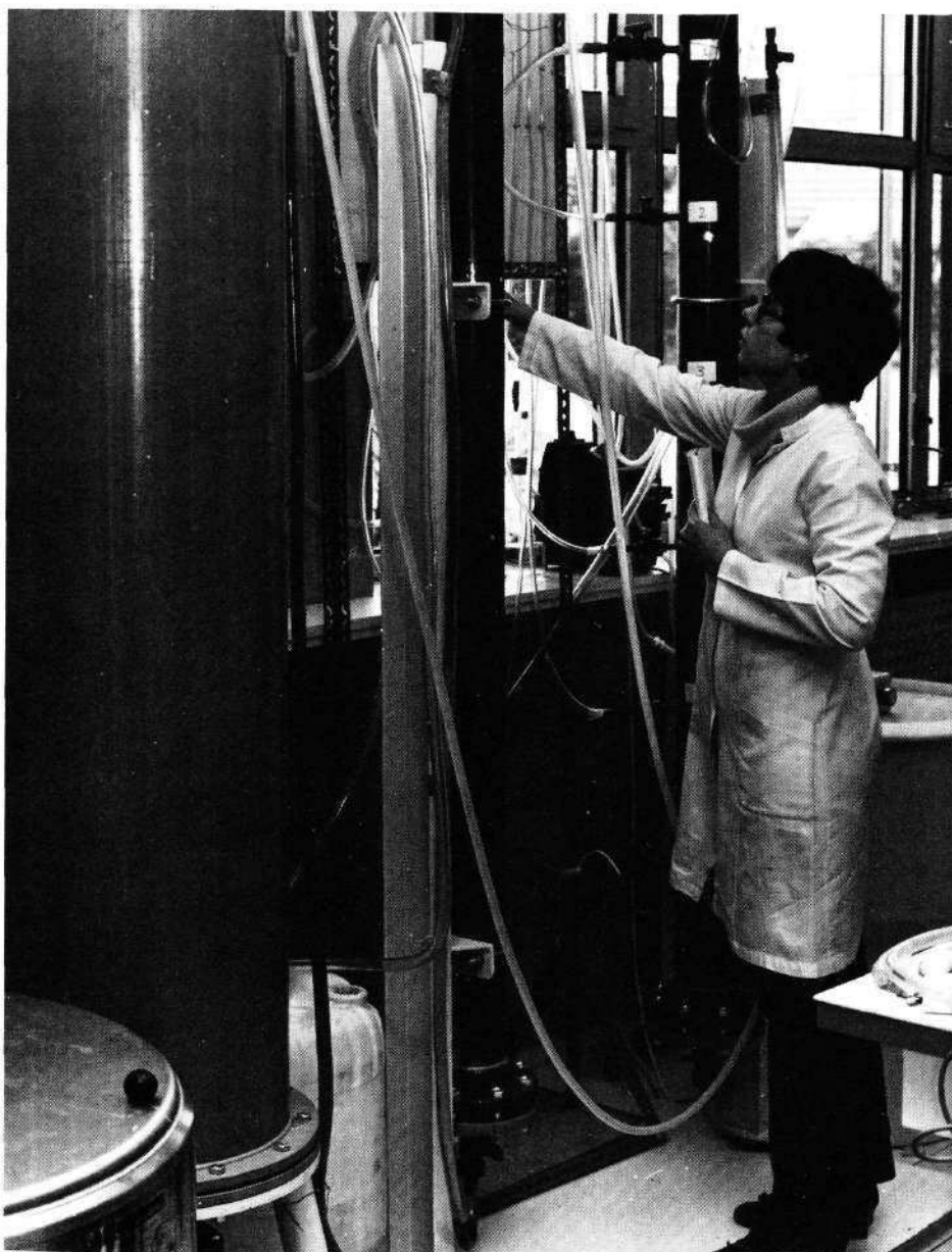
5 - Installation pilote de méthanisation d'eaux résiduaires urbaines au Laboratoire Central de la Lyonnaise des Eaux.
