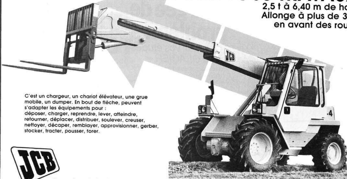
C'est un chargeur, un chariot élévateur, une grue mobile, un dumper. En bout de flèche, peuvent s'adapter les équipements pour : déposer, charger, reprendre, lever, atteindre, retourner, déplacer, distribuer, soulever, creuser, nettoyer, décaper, remblayer, approvisionner, gerber, stocker, tracter, pousser, forer.
