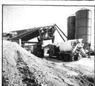
Centrales mobiles : 40 à 80 m 3 /h tractables (2,5 à 3 m hors tout), par un seul camion. Silo à ciment incorporé de 30 t. Gachées sèches avec MOB 80 GS.
