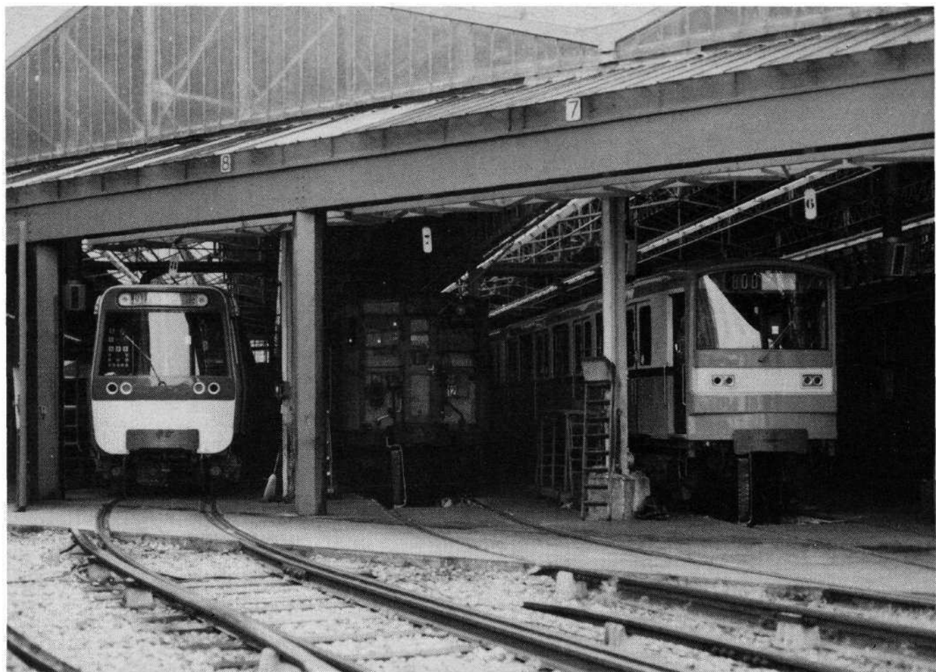
Les matériels modernes, MF 67 à droite et MF 77 à gauche, encadrant l'ancien matériel Sprague.
