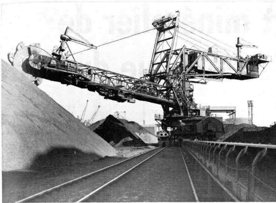
Engin de reprise : roue pelle
