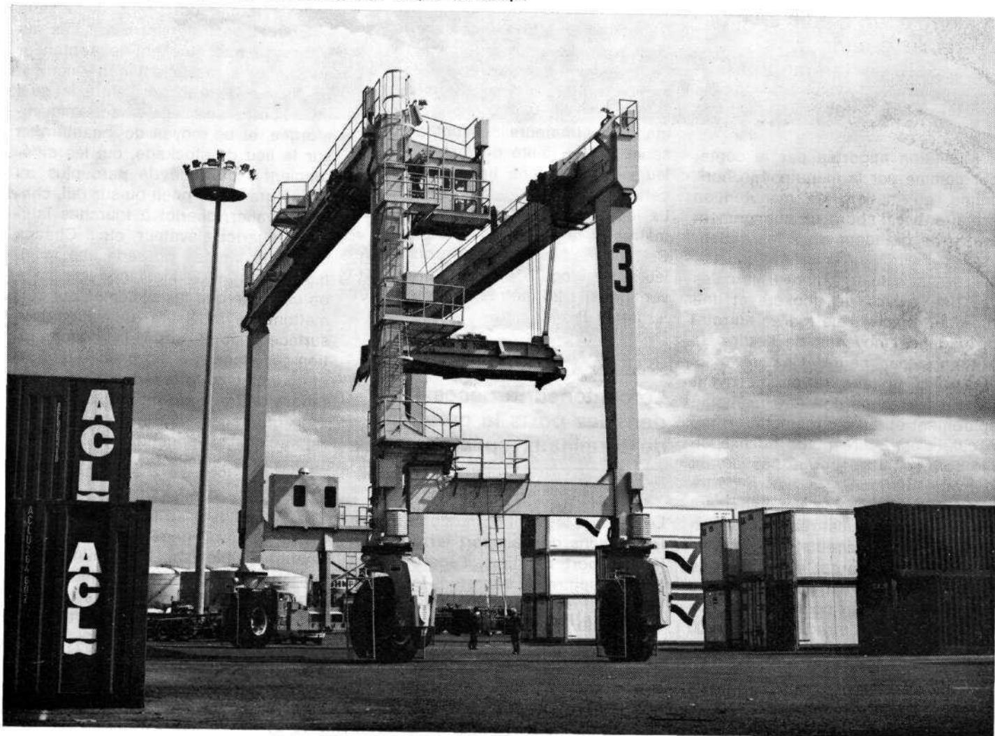
Port du Havre. Portique de parc sur pneus au terminal du quai de l'Europe
