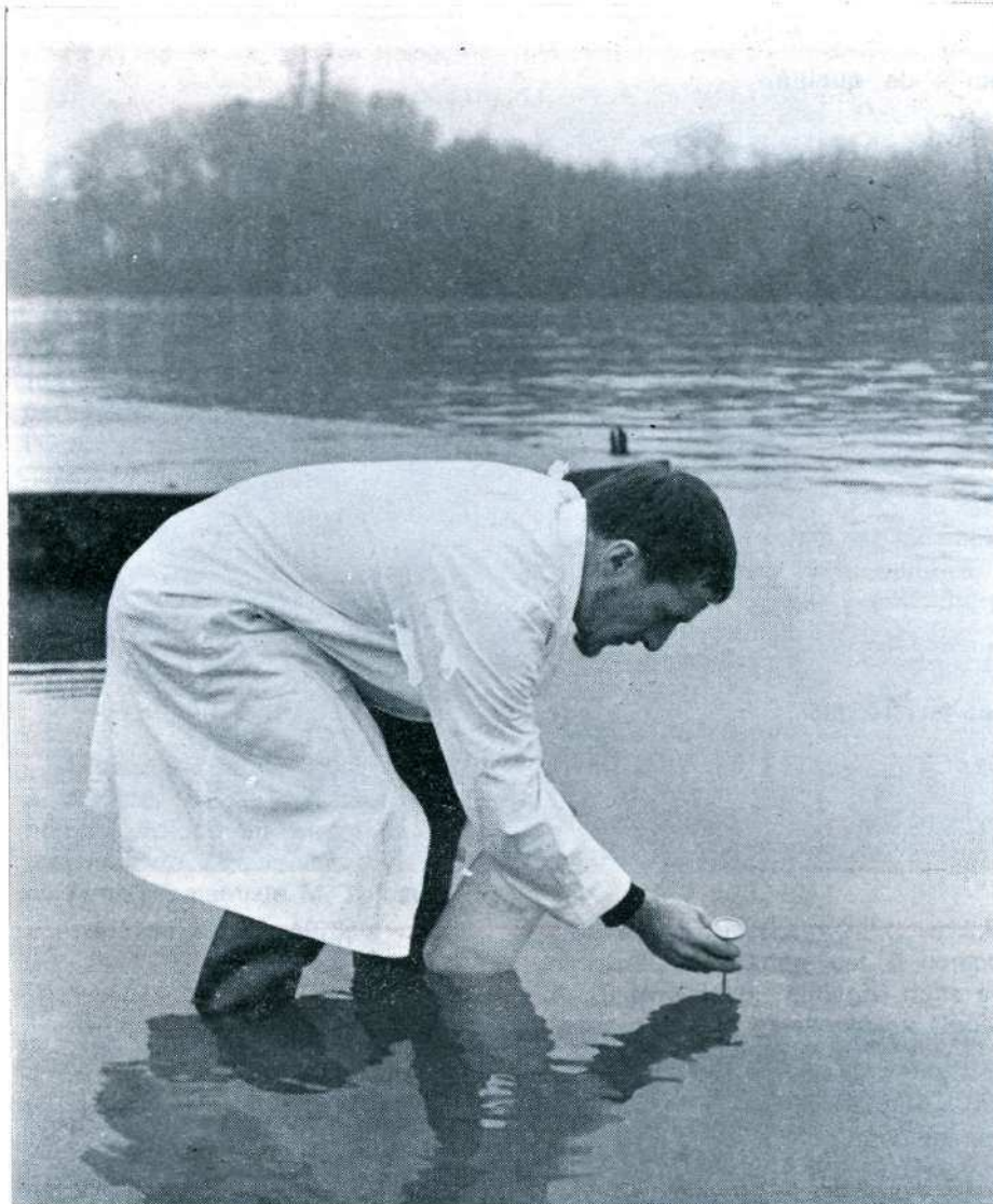
Prise de température de l'eau pour analyse de pollution.
