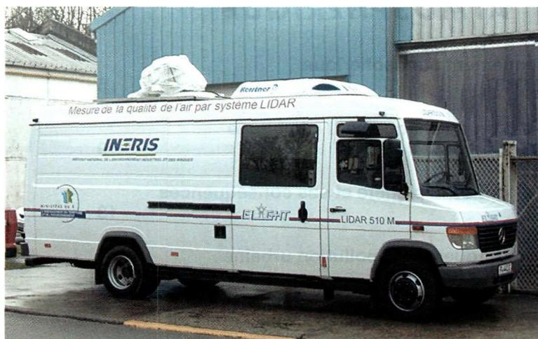
Le LIDAR (Light Detection And Ranging), sorte de radar optique, est un système d'analyse de la qualité de l'air, qui repose sur une technologie Laser. Il permet de mesurer à distance la concentration de différents polluants présents dans l'atmosphère et ainsi de les localiser à une distance pouvant être de plusieurs kilomètres.
