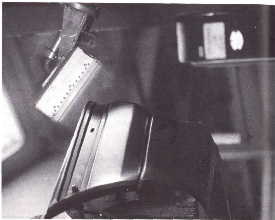
Flammage des pare-chocs pour l'adhérence de la peinture.
