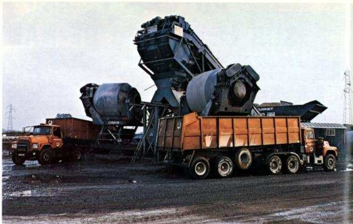
Centrale à béton HELTZEL : 400 m 3 /heure
