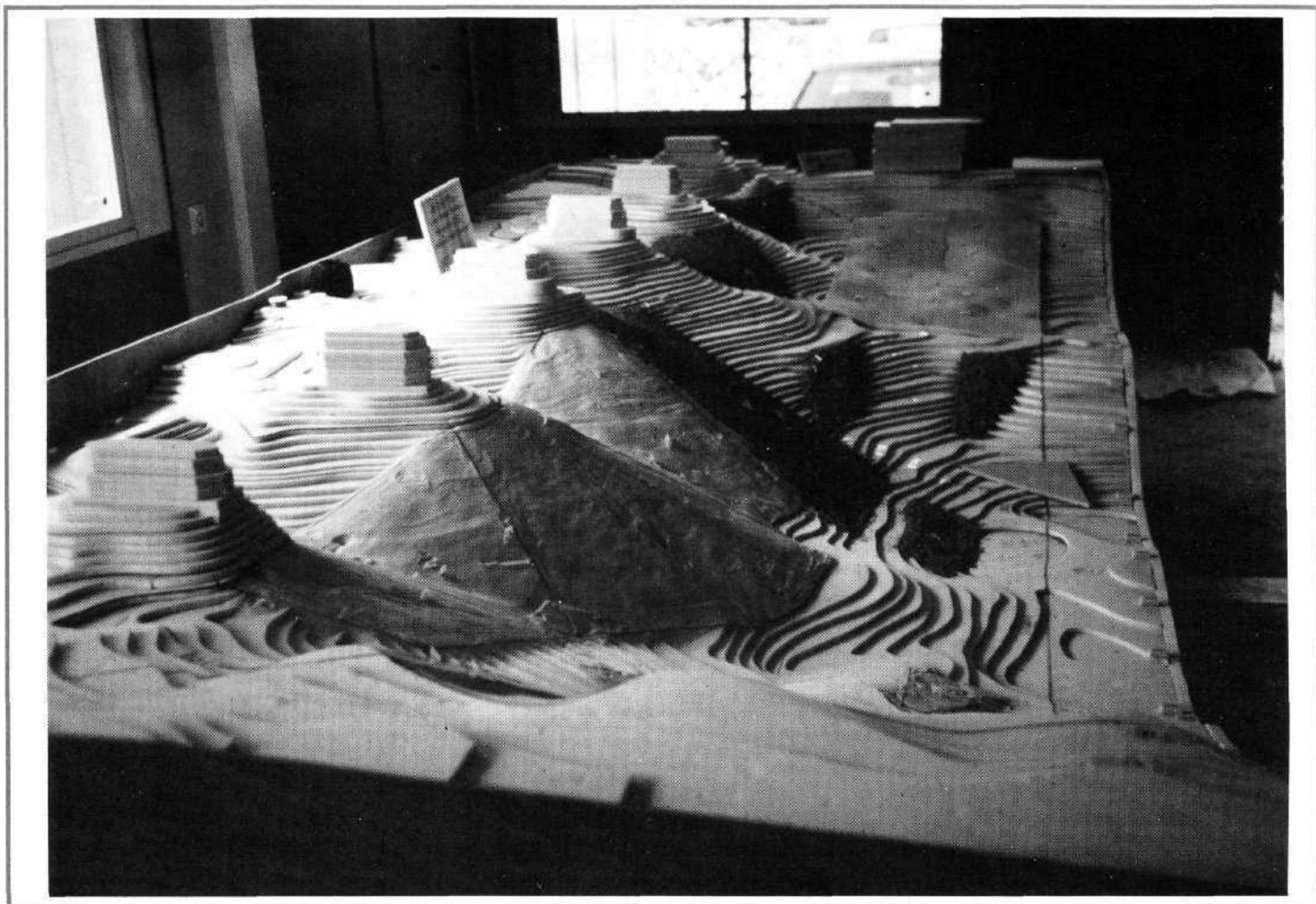
Fig. 1 : Affouillements de fondations dans la Loire (maquette).
