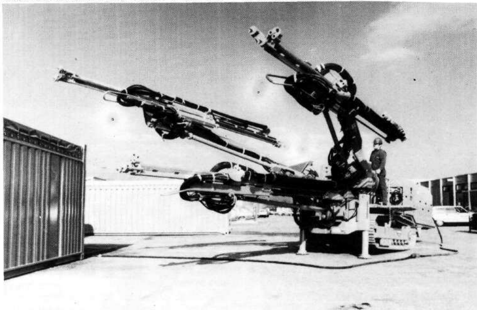
Pour les creusements ; Jumbo Montabert 3 bras (photo D.R.).
