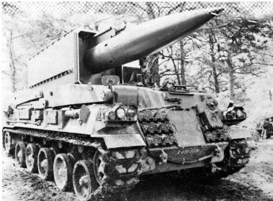
Char Pluton. (Châssis A.M.X. 30).
