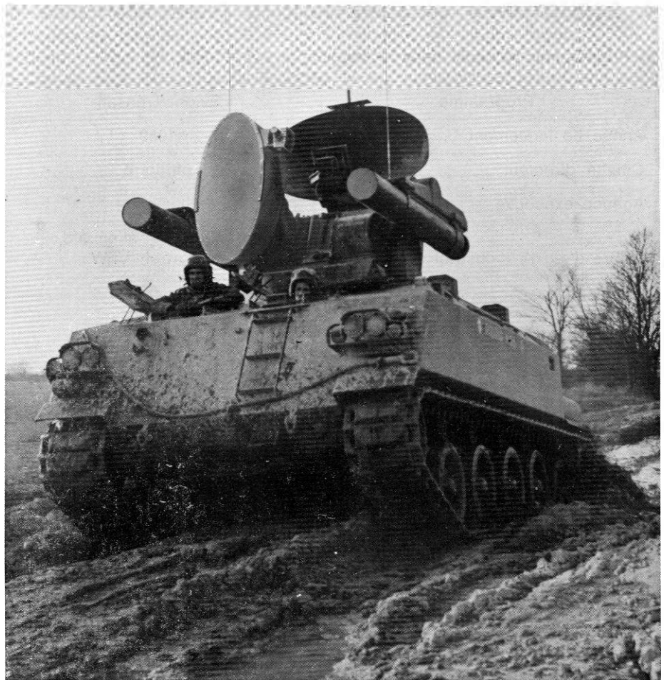
Missile anti-aérien Roland sur châssis A.M.X. 30.
