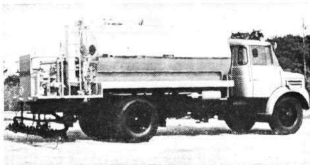
Equipement épandeur à transmission hydrostatique
