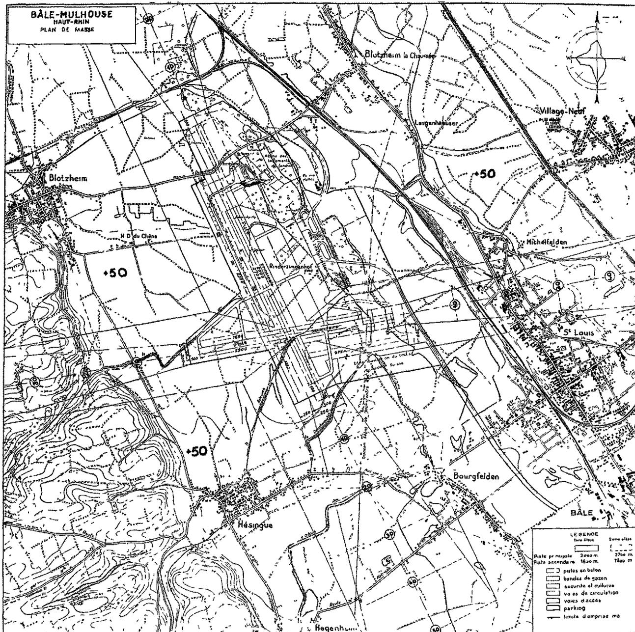
siblement E.-O. de 1.600 mètres de longueur, l'autre sensiblement N.-S. de 2.000 mètres qui sera dotée des dispositifs d'atterrissage par mauvaise visibilité. Les deux pistes auront une largeur de 60 mètres. 4.420 mètres de voies de circulation desserviront les pistes et les relieront à des aires de stationnement totalisant 150.000 mètres carrés environ.
