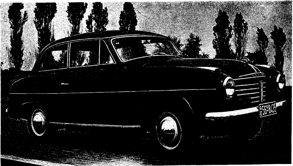
GOLIATH — Voiture 2 cylindres 2 temps à injection d'essence
